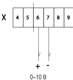
Функция вывода данных о состоянии в виде сигнала 0–10 В активируется программным способом (подробнее см. в «Меню 4.4 – Выход»). Информация об уровнях напряжения в зависимости от состояния в разных режимах представлена в «Технических характеристиках» «Значения напряжения на выходе и соответствующие данные о состоянии в различных режимах».
