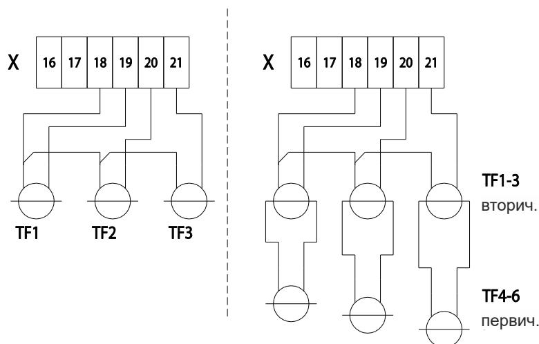
В левой части представленного выше изображения показано подключение относительно маленьких главных предохранителей (<70 A), когда токовые трансформаторы Jäspi (TF1-3) можно использовать напрямую (в зависимости от размера кабеля питания). В правой части изображения показано подключение, когда требуются трансформаторы первичного тока (TF4-6), а токовые трансформаторы Jäspi (TF1-3) используются в качестве трансформаторов вторичного тока.
