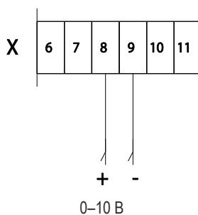
Функция внешнего управления 0–10 В активируется программным способом (подробнее см. «Меню 4.3 – Вход»). Информация об уровнях напряжения по ступеням мощности в разных режимах представлена в Технических характеристиках» «Значения внешнего управляющего напряжения (на входе) и соответствующие ступени мощности в различных режимах».
