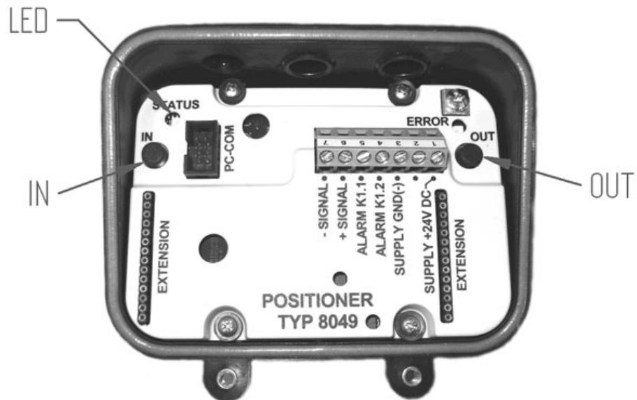
2. La vanne s'ouvre et se ferme plusieurs fois, puis la DEL s'éteint. Les erreurs éventuelles sont signalées par une DEL rouge (par ex. pression d'air d'arrivée insuffisante).
