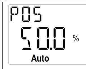
Une fois l'autocalibrage terminé et effectué correctement, le régulateur commute automatiquement en mode normal.
