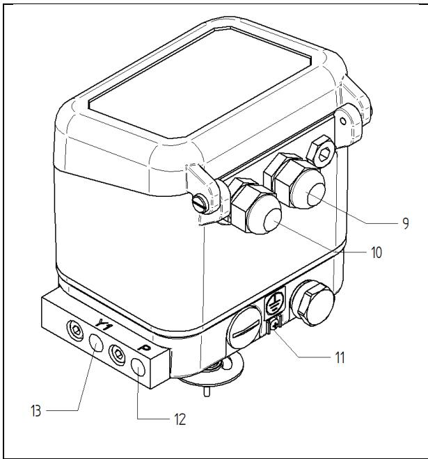
Die Versorgungsluft wird mit dem Eingang „P“ (12) verbunden (G1/8“).
