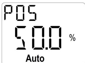
Auf dem Display wird die aktuelle Ventilposition in Prozent angezeigt.
