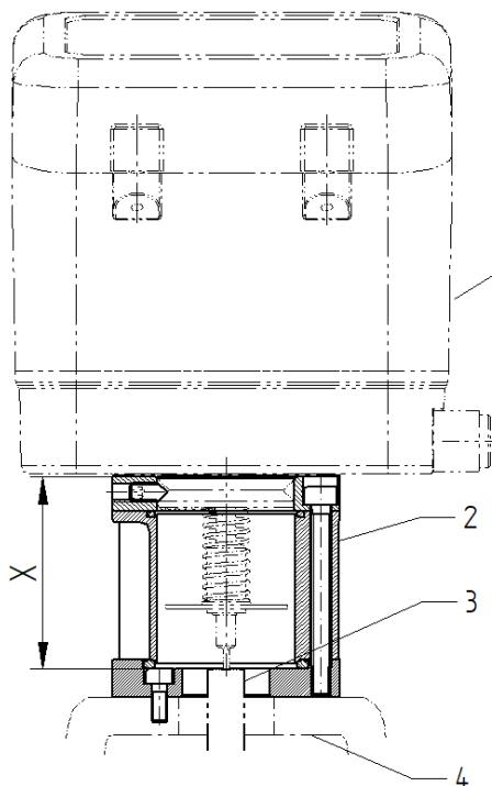
Der Anbausatz wird an der Oberseite des Ventilantriebs befestigt. Je nach Ventilbauart kann diese Befestigung unterschiedlich sein.
