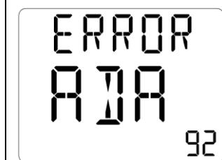
Si le code 92 est affiché, la détermination de la durée d'impulsion a échoué.
