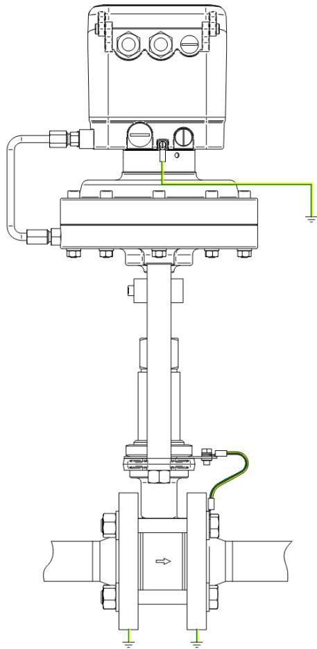
Erdungsanschluss für GS-Ventile mit Membranantrieb
