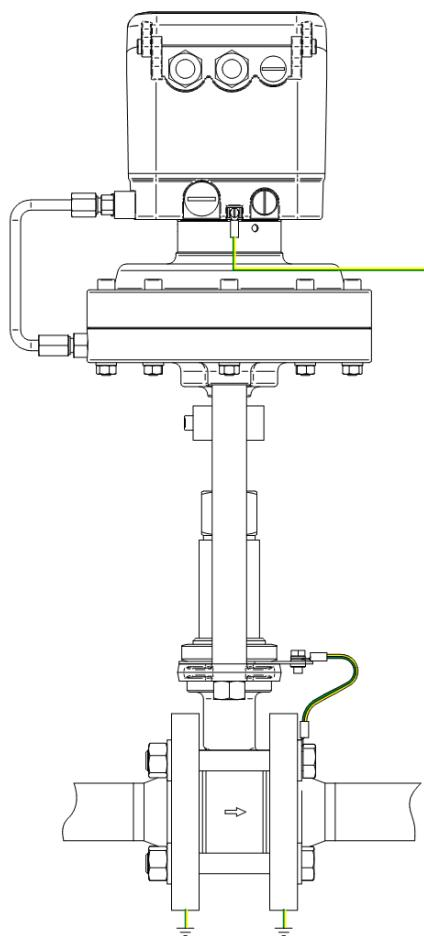
Raccordement de mise à la terre pour vanne GS avec actionneur à membrane
