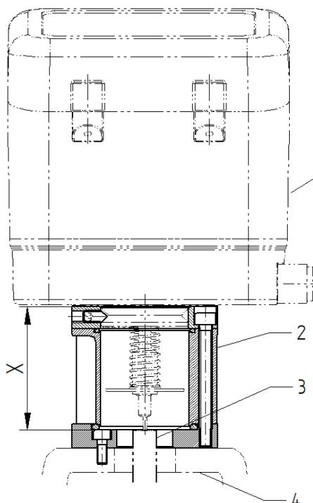
Le kit de montage est fixé sur la partie supérieure de la commande de la vanne. Ce montage peut être différent selon la conception de la vanne.
