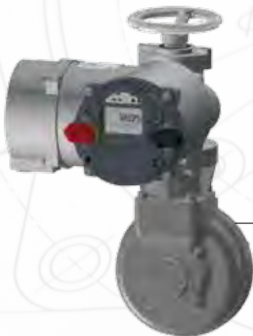
CM-DREHANTRIEB MIT KEGELRAD-ODER STIRNRADGETRIEBE CM-ROTARY ACTUATOR WITH BEVEL GEAR OR HELICAL GEAR MECHANISM Drehmomente bis 550 Nm z. B. für Schieber bis ca. Nennweite 400 Ausgangsdrehzahl 0,4 bis 18 U/min Torques up to 550 Nm Example: gate valves up to DN 400 Output speed: from 0.4 RPM to 18 RPM
