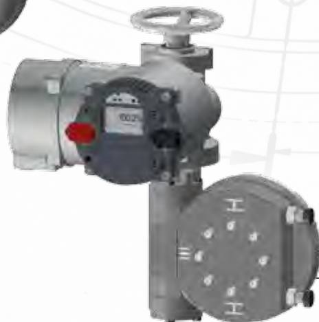
CM-DREHANTRIEB MIT SCHNECKENRADGETRIEBE CM-ROTARY DRIVE WITH WORM GEAR MECHANISM Drehmomente bis 25.000 Nm z. B. für Klappen, Hähne & Segmenthähne etc. bis ca. Nennweite 1.000 Stellzeiten von 7 bis 900 sec Torques up to 25,000 Nm Example: butterfly valves, ball valves, dampers up to DN 1,000 Positioning times from 7 s to 900 s
